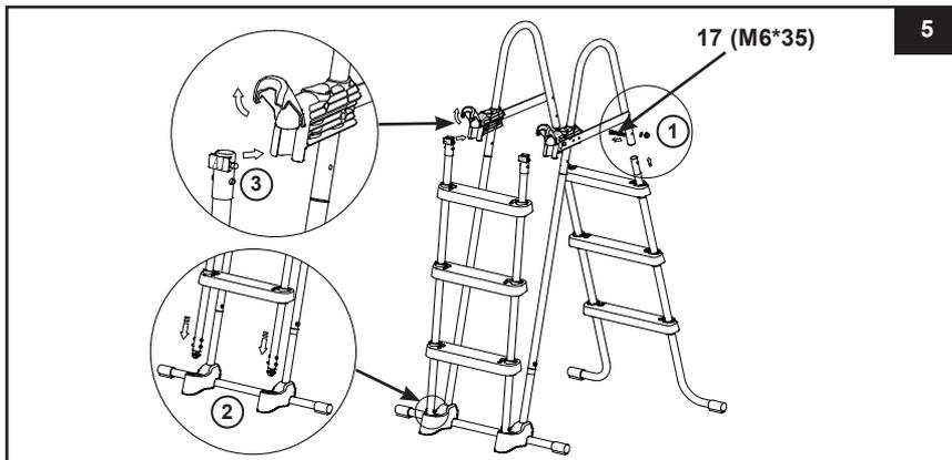
**6. ENTRETIEN :** Inspectez régulièrement tous les écrous, vis, marches et manchons d'ancrage de marche pour vérifier que toutes les pièces sont solidement fixées et que l'échelle est solide.
